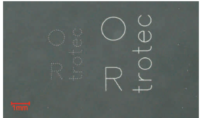
Abb. 4: Markierung auf Polycarbonat, gepunktete Markierung (links) mit niedrigem Kontrast und durchgezogene Vektoren für hohen Kontrast (rechts).
