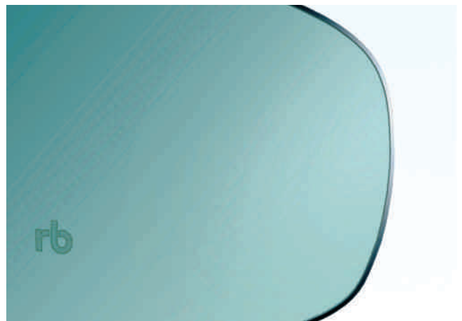
Abb. 2: Stark kontrastierende Marketingmarkierung auf getöntem Mineralglas, erstellt mit dem vorgestellten Verfahren, in der Praxis wäre eine derartige Markierung am Rand der Linse.
